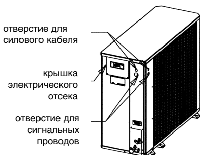
Рис. 9 Подключение электрических кабелей
